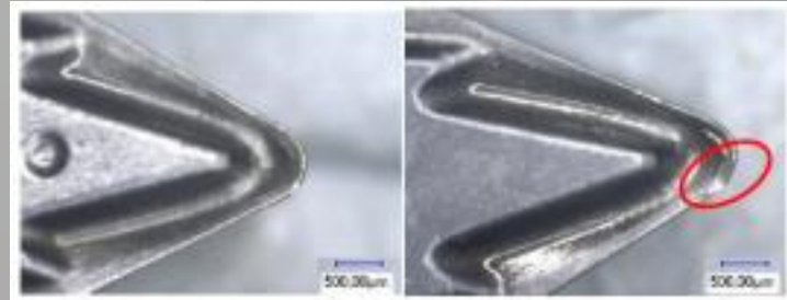
Platte 1 (links) - NEU Platte 2 (rechts) – Verschlissen
